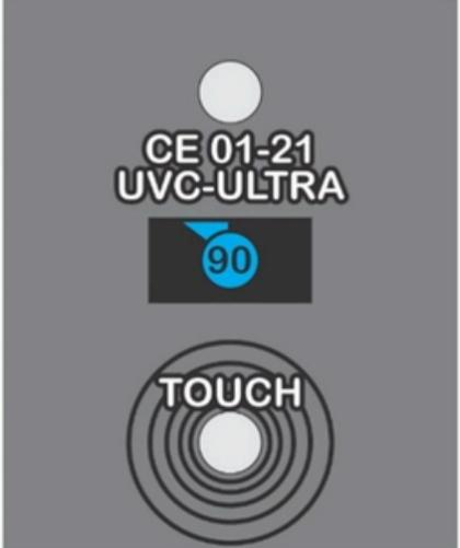
Chegando ao termino do processo de esterilização, a ultima tela da sequênica de porcentagem será a de 90% concluindo esta ultima parte uma sequencia rápida de 10 bips curtos será emitida pelo equipamento avisando que o processo de esterilização chegou ao fim, onde uma tela com a mensagem de "SUCESSO" .
