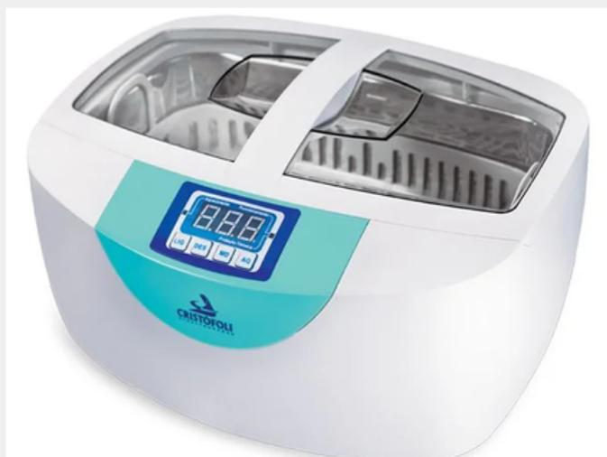
Os instrumentos devem ser pré-higienizados em uma cuba ultrassônica por pelo menos 7 a 8 minutos, conforme os procedimentos padrão utilizados para a esterilização por autoclavagem.
