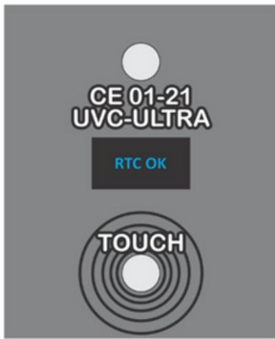
Ao ligar a caixa esterilizadora na tomada, a primeira mensagem a aparecer no *display* "RTC OK" indica que o relógio interno foi conectado com sucesso.
