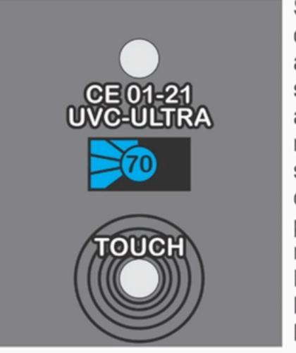
Se durante o processo de esterilização o sistema de segurança identificar algum erro, imediatamente o processo será interrompido, as lâmpadas se apagarão e uma tela de erro será mostrada no *display* seguido de alertas sonoros (bips) avisando ao operador qual tipo de falha ocorreu durante o procedimento e o instruindo a realizar novamente o processo de esterilização.
