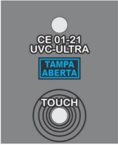
Se após o toque no sensor *touch* o sistema identificar que a tampa se encontra aberta ou não fechada corretamente a seguinte mensagem de erro aparecerá no *display*: "TAMPA ABERTA FECHER A TAMPA" esta mensagem permanecerá até que a tampa seja corretamente fechada, voltando o *display* a apresentar o relógio com DATA/HORA necessitando que o operador efetue novamente o toque no sensor *touch* para que se reinicie o processo de esterilização.
